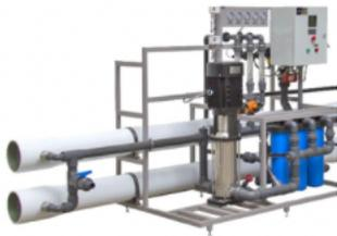
Промышленные системы обратного осмоса серии RO предназначены для деминерализации пресной воды (степень очистки до 99 %), удаления тяжелых металлов, микробов, бактерий, органических и неорганических соединений. Типичная конверсия для подземной и поверхностной воды пресного типа составляет до 75 %.
